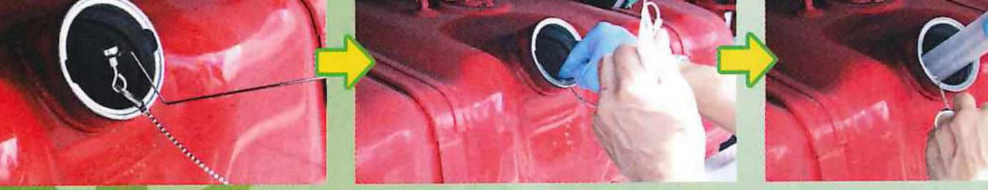
ツールとマグネットを燃料タンクのな ッールを上へ動かし、タンクの上部 CFV本体を燃料タンクに投入する。 にマグネットを付ける。 左の写真の給油口の中心に見えるのがCFVに付いたチェーン。今回の製品は鉄製タンク用だが、マグネットが装着できないアルミやステンのタンクに対応したアダプターを現在考案中とのことだ。
